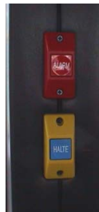
Bonne terminologie (utilisation des termes « halte » et « alarm »), pas de confusion possible au niveau des couleurs
