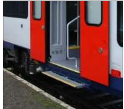
Malgré le déploiement, sur ce Desiro, d'un marchepied, les lacunes tant horizontale que verticale sont importantes. L'accostage se fait ici à un quai bas. Les Desiro sont particulièrement inadaptés à ce type d'infrastructure..
