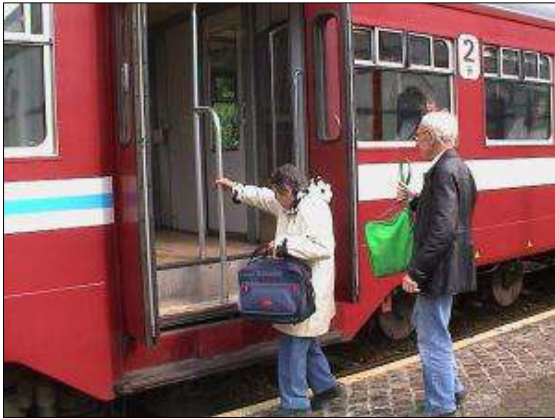
La hauteur des marches à franchir pour embarquer est rebutante. Les personnes âgées sont particulièrement touchées lorsqu'elles sont confrontées à une telle situation. (Esneux)
