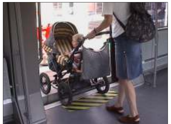
Le « Talent » du constructeur Bombardier autorise un débarquement sécurisé par le plain-pied.
