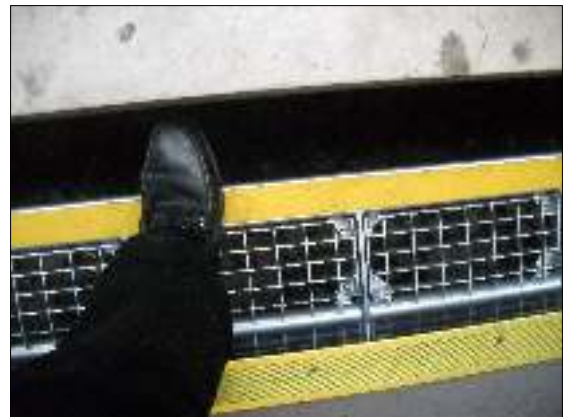
Le marchepied du Desiro ne permet pas de combler la lacune entre véhicule et quai. Le risque de trébucher est grand, le geste requiert l'attention et l'habileté de l'utilisateur.
