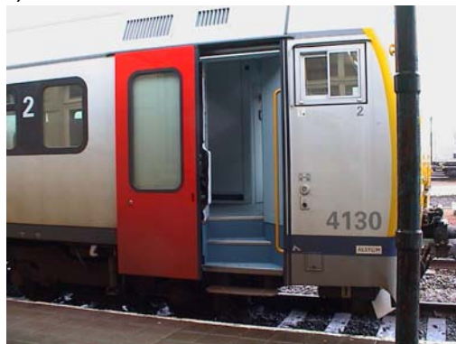
Dotés de portes étroites aux extrémités et d'un emmarchement important, certains matériels SNCB comme l'AR41 sont loin d'être des modèles d'accessibilité. © ACTP
