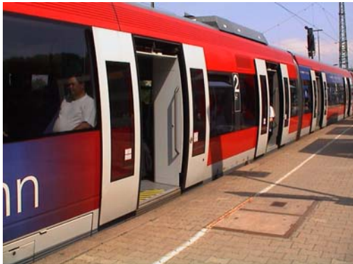
Bon nombre de nos voisins européens bénéficient d'un matériel ferroviaire moderne. En Allemagne, le Talent de Bombardier dispose de larges portes bien réparties, à doubles battants et d'un accès aisé. © ACTP
