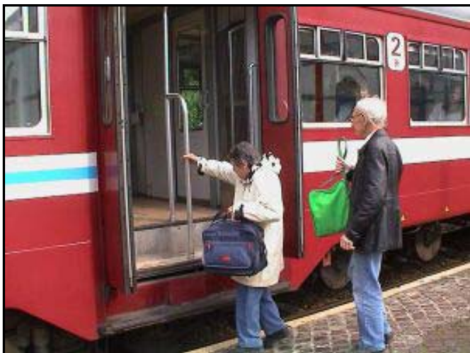
Emmarchement du matériel actuellement en service sur la ligne 43. L'accès est particulièrement pénible pour les personnes âgées. Sur les rames « rénovées », la rampe centrale a été supprimée ce qui rend l'accès encore plus difficile.
