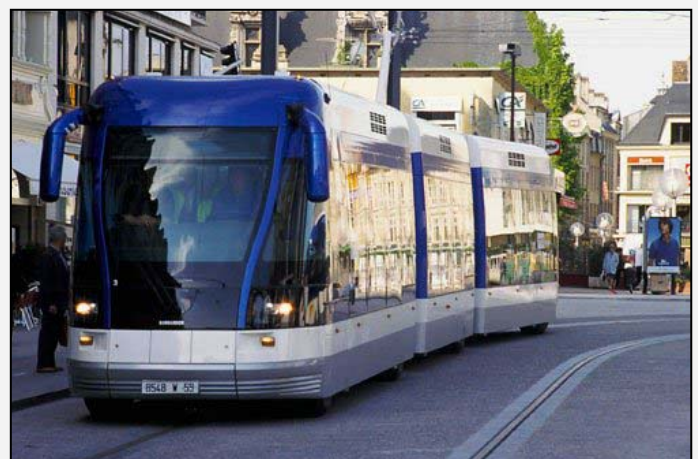
Le tram sur pneus de Caen (guidage par rail central)
