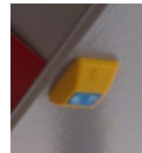
Disposé au plafond, ce bouton de demande d'arrêt est peu accessible
