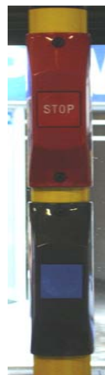
Mauvaise terminologie : le terme « stop » est réservé au bouton d'alarme alors que rien ne figure sur le bouton de demande d'arrêt
