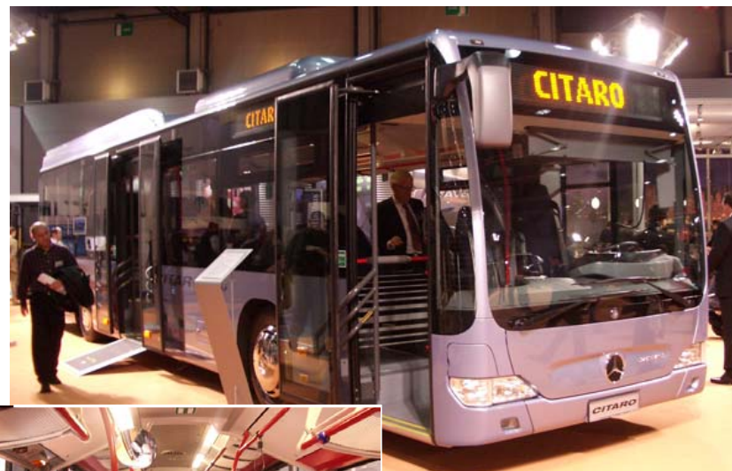
Le nouveau modèle Citaro : plancher bas entre les deux portes et intérieur confortable
