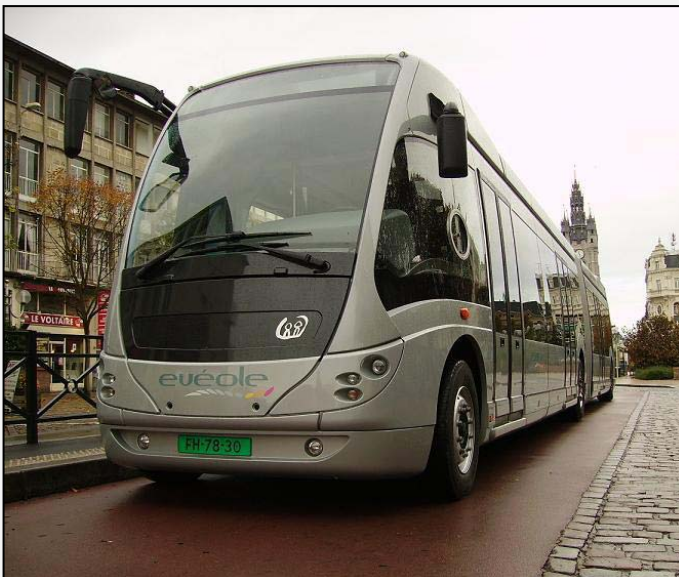
Développé par APTS, une filiale de la société néerlandaise VDL, le Phileas est un bus hybride guidé au sol par des aimants. Déjà en service à Eindhoven depuis 2004 (où il effectue les liaisons entre la gare et l'aéroport), ce bus à haut niveau de service roulera à Douai d'ici l'été 2008. Le Phileas tire son nom de Phileas Fogg, le protagoniste du roman de Jules Verne, Le Tour du monde en 80 jours, du fait de la vitesse élevée et de la ponctualité.
