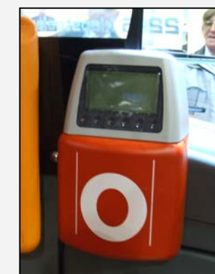
Le New A 330 de la Stib était équipé d'un valideur MoBIB. Fonctionnant avec une carte à puce destinée à remplacer les anciens titres de transport, ce système sera progressivement installé à chaque entrée de station de métro, dans les trams et à bord des bus. Il suffit de passer la carte à proximité de la zone de validation pour enregistrer son trajet. L'écran permet quant à lui d'afficher toutes les informations contenues sur la carte.
