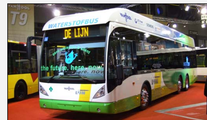
Le Van Hool A 330 Fuel Cell, bus à hydrogène
