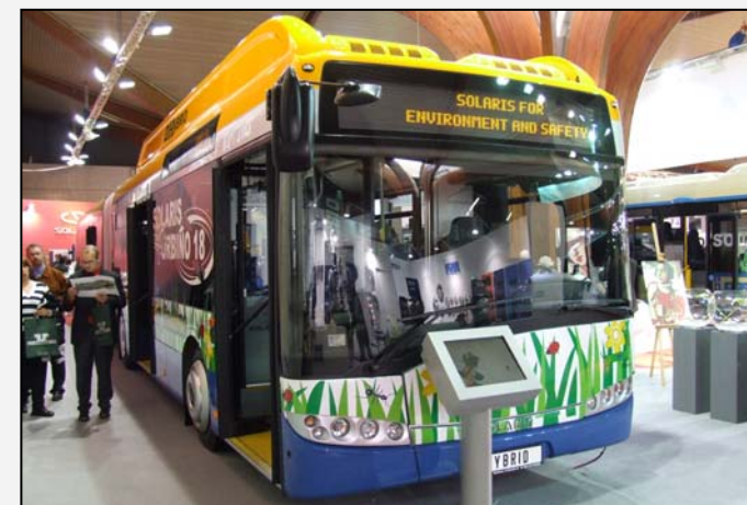
Solaris exposait aussi cet Urbino 18 hybride. Ce bus articulé roule principalement en Allemagne mais aussi à Lenzburg en Suisse. S'il permet une économie de carburant de l'ordre de 20%, son prix d'achat est deux fois supérieur à celui d'un véhicule ordinaire. © ACTP
