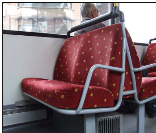
L'épaisseur des sièges permet ici d'effacer partiellement les chocs verticaux. © ACTP
