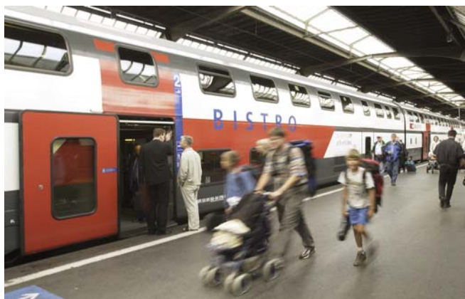
L'IC2000 des CFF est un matériel double étage qui présente la particularité d'avoir deux larges portes entre les bogies, ce qui permet un embarquement de plain-pied face à un quai haut. De plus ; l'intercirculation se fait au niveau supérieur : toute la rame peut ainsi être parcourue de plain-pied. © CFF
