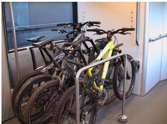
A l'instar du Talent de Bombardier qui possède une large plate-forme multimodale, le Flirt de Stadler est équipé de racks horizontaux permettant de ranger les vélos. © ACTP
